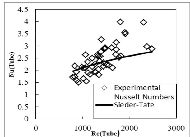
Fig: Nu (tube) vs Re (tube)
